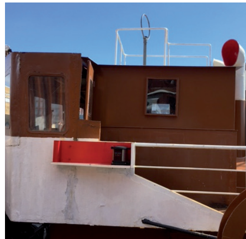
Richtingzoeker met hekwerk op de brug
